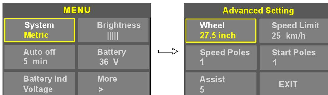
**8.1 Système:** appuyer sur les boutons HAUT/BAS pour basculer entre le système métrique et le système impérial.
