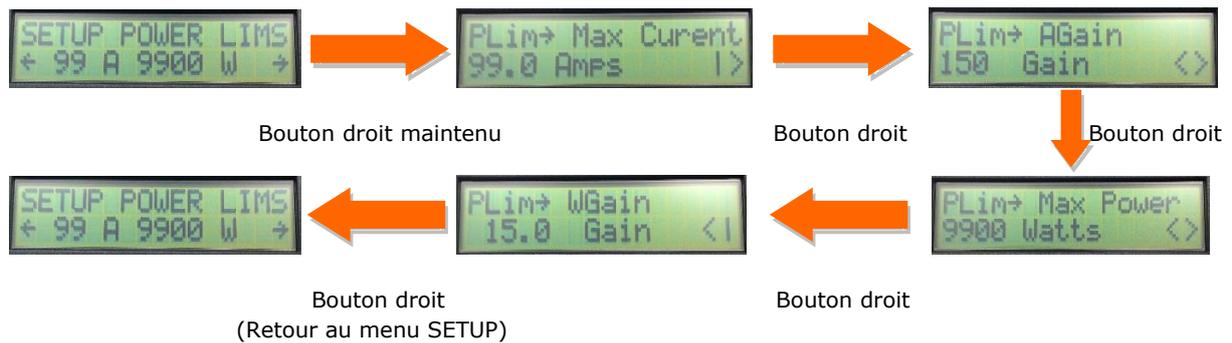
**Max Curent** : Permet de régler une limite max de courant. Par exemple si vous souhaitez brider la puissance de votre installation, vous pouvez diminuer le niveau de courant envoyé au moteur. Si votre contrôleur délivra au maximum 30A et que vous réglez cette valeur sur 15A, la puissance sera divisée par deux.
