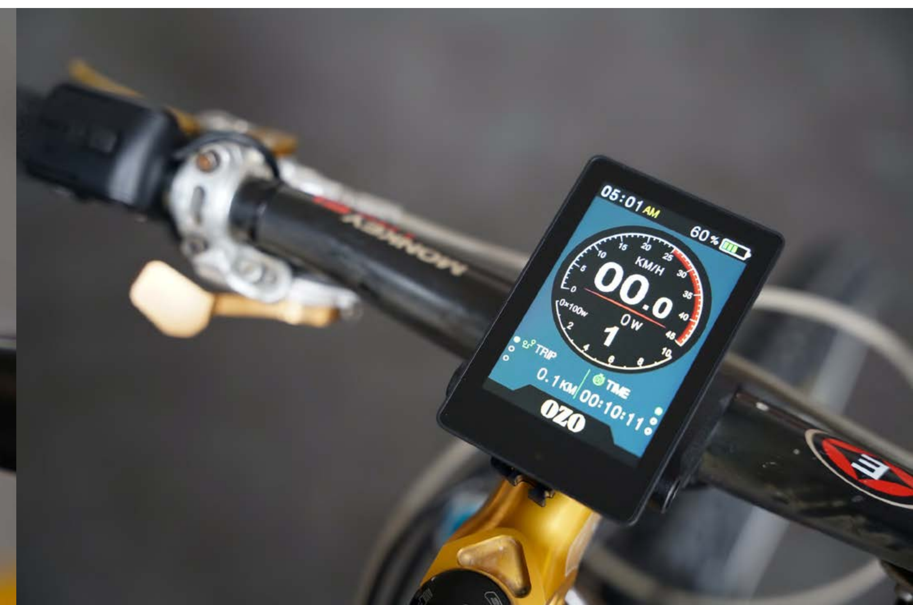
LE DISPLAY VERTICAL COULEURS EST LE HAUT DE GAMME. IL AFFICHE PLUS DE PARAMÈTRES ET DISPOSE D'UN PORT USB POUR RECHARGER UN SMARTPHONE OU GPS
