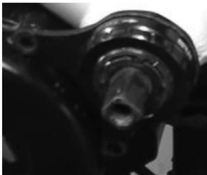
Vissez la patte de fixation sur le moteur pédalier. Placez une rondelle entre la patte et le moteur ET entre la patte et la tête de vis.
