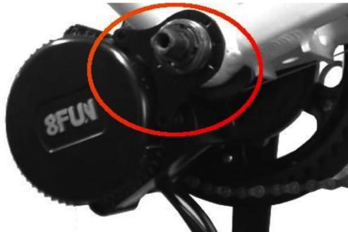
Vissez le moteur pédalier avec l'écrou. Mettez une goutte de frein filet afin d'éviter les desserrages intempestifs dus aux vibrations. Utilisez la douille noté A sur le schéma page 11. Avant de serrer, assurez-vous que le moteur pédalier ne gêne pas de câble en laissant un jeu entre le moteur et le cadre. Serrer à un couple de 60 N.m.
