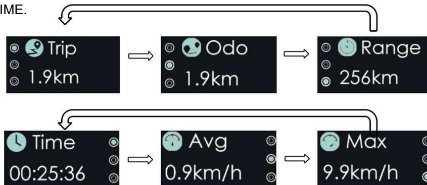
\* S'il n'y a aucune opération pendant 5 secondes, l'élément de droite sera automatiquement remis sur le temps.
