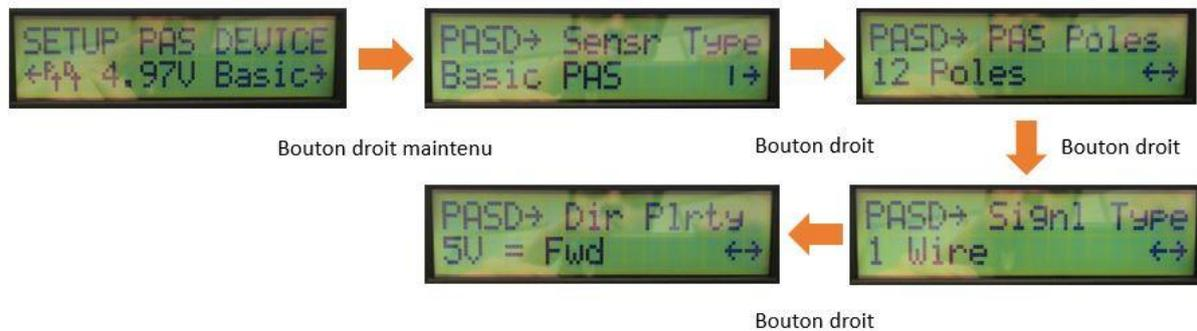
**Sensr Type** : Permet de sélectionner le type de capteur pédalier. **Valeur par défaut : Basic PAS**
