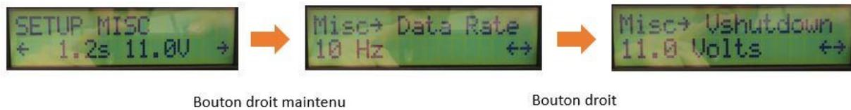
**Data Rate** : Sélectionner la fréquence de données. Plus la fréquence est élevée, plus il y a de données et plus le fichier est volumineux.
