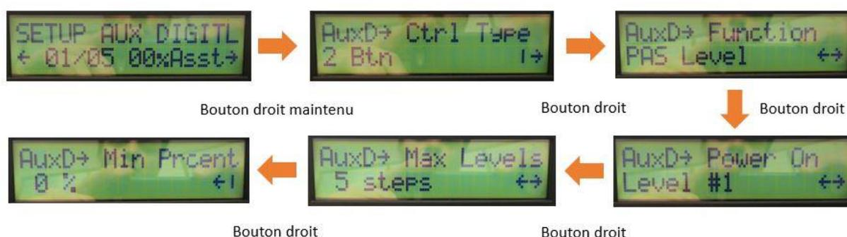
**Ctrl Type** : Sélectionner le type de commande pour ajuster le niveau d'assistance (1 bouton, 2 boutons).
