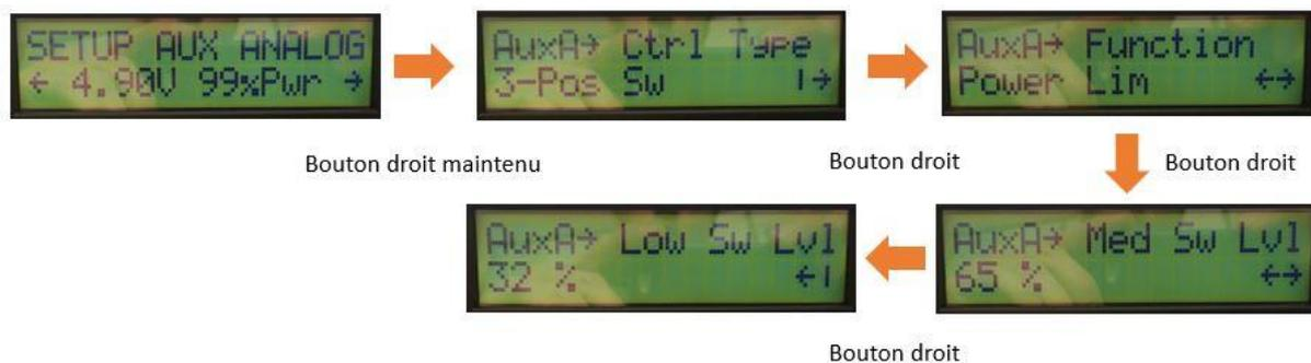
**Ctrl Type** : Sélectionner le type de commande pour ajuster le niveau d'assistance (potentiomètre, switch 3 positions, switch 2 positions).
