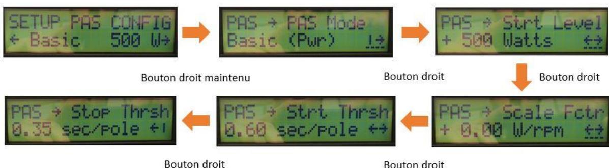
**PAS Mode** : Permet de sélectionner le type d'assistance au pédalage (puissance, couple si vous disposez d'un capteur couple). **Valeur par défaut : Basic (Pwr)**
