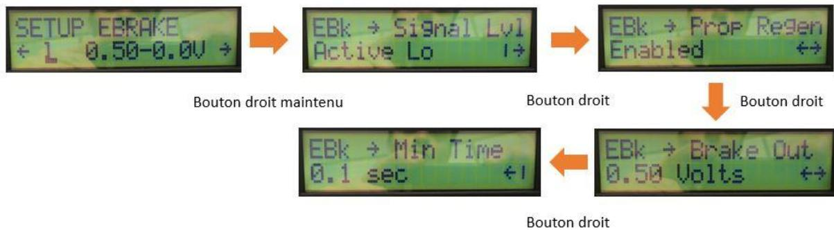
**Signal Lvl** : Sélectionner le niveau de regen (faible ou élevé). La regen fait office de frein moteur sur un moteur thermique, c'est-à-dire que lors du freinage le frein régénératif se déclenche ce qui permet de générer de l'électricité pour recharger la batterie.
