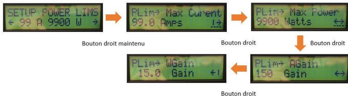
**Max Curent** : Permet de régler une limite max de courant.
