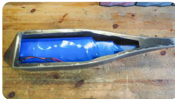
Batterie conçue pour rentrer dans un réservoir de moto vintage
