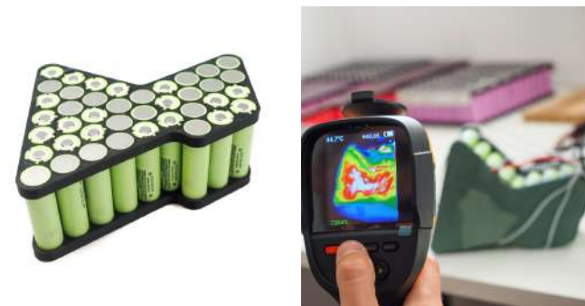
Géométrie sur-mesure et contrôle de température par caméra thermique durant la phase de tests
