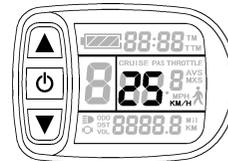
Dans les 5 premières secondes qui suivent l'allumage du display, maintenez et appuyés pour accéder aux paramètres généraux. KM/H et MXS s'allument, et la vitesse maxi clignote. Appuyez brièvement sur ou pour paramétrer la vitesse maximum (25KM/H par défaut). Appuyez brièvement sur pour atteindre le paramètre suivant.
