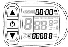
Attendez 5 secondes après l'allumage du display, et maintenez simultanément et appuyés. Les indicateurs de temps de voyage (TM) et de distance parcourue (DST) clignotent. Appuyez brièvement sur pour réinitialiser ces deux données. Sinon, après 5 secondes sans appuyer sur le bouton, le display retournera automatiquement à l'écran 1 et les données seront conservées.
