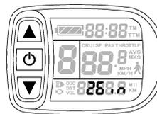
Le paramètre suivant permet d'insérer le diamètre de la roue dans le display, le paramètre clignote alors. Appuyez sur ou pour changer les spécifications du diamètre, parmi les valeurs : 6, 8, 10, 12, 14, 16, 18, 20, 22, 24, 26, 700c et 28 pouces. Appuyez sur pour atteindre le paramètre suivant.
