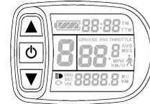
Maintenez appuyé pour allumer la lampe avant et le rétro-éclairage ; maintenez appuyé à nouveau pour les éteindre.
