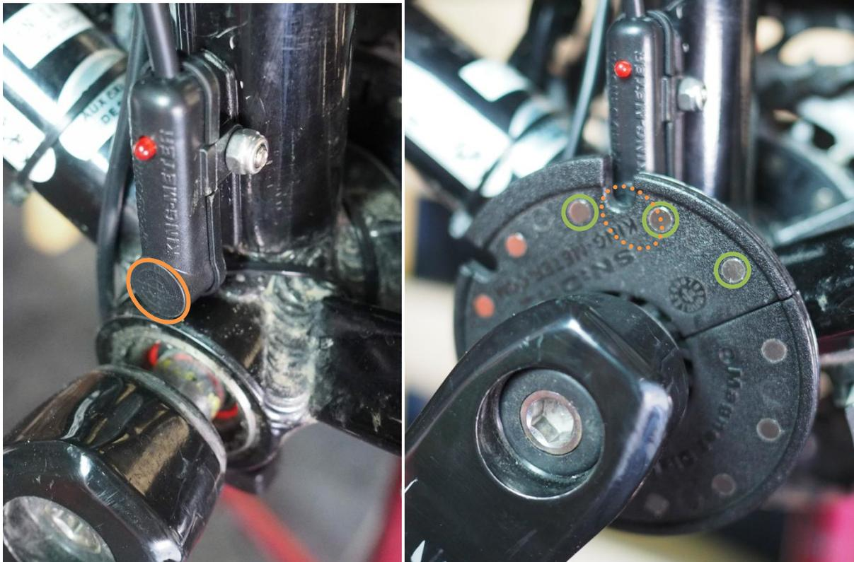
Il suffit de coller cette sonde sur le cadre, en mettant bien **la cible** au niveau des **aimants**. Sécurisez l'installation en fixant la sonde au cadre avec deux colliers plastique.
