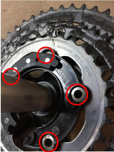
Les vélos de route sont en général équipés d'un pédalier à 5 vis cheminées. Il faut alors installer l'adaptateur pour le capteur pédalier. Il suffit de faire correspondre 4 des 5 vis cheminées avec les 4 trous de l'adaptateur.
