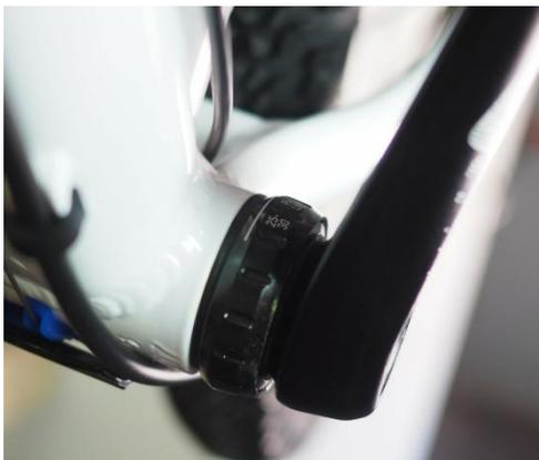
Sur ces boîtiers, il faut installer un **capteur pédalier à disque côté transmission**.
