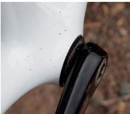
Les roulements sont intégrés au cadre. Les manivelles sont très proches du cadre.
