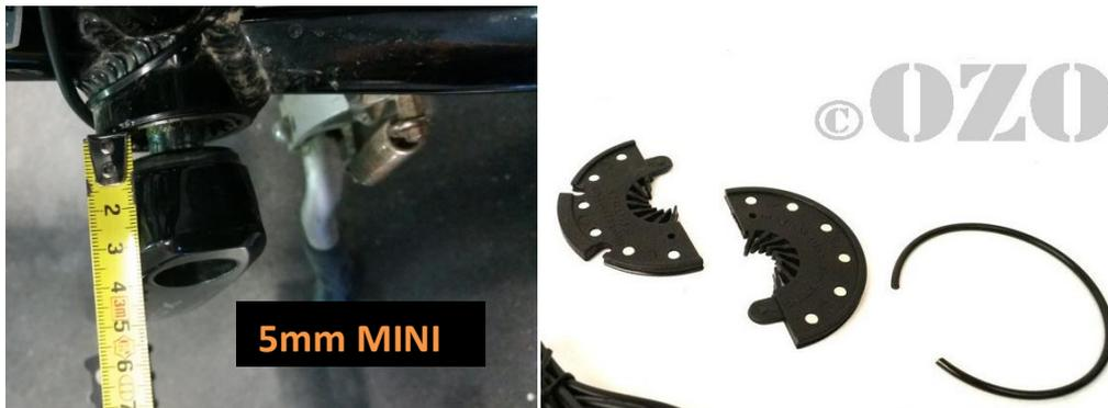
Il ne nécessite pas de démontage car le disque aimanté s'ouvre en deux parties.
