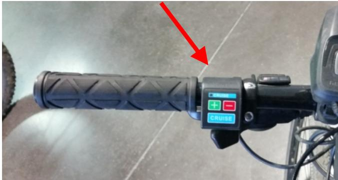
Le régulateur de vitesse est à fixer sur le guidon de votre vélo. Le verrouillage sur le guidon se fait à l'aide d'un tournevis cruciforme.
