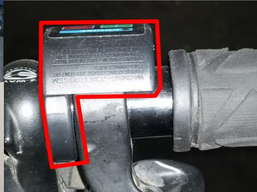
\* Le régulateur est prévu pour être installé sur un diamètre de guidon de 22mm.
