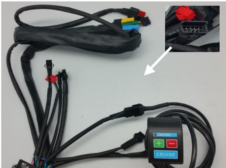
Le régulateur est à connecter sur la prise JST 5 voies du [contrôleur OZO](#)
