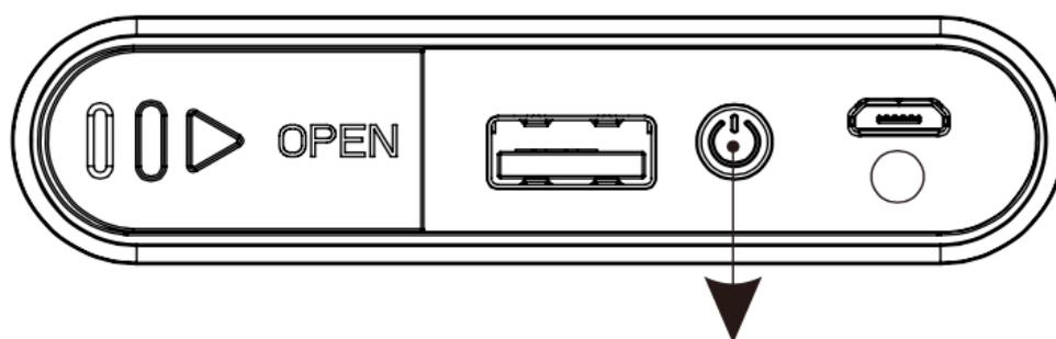
Appuyer une fois sur le bouton pour démarrer l'appareil : l'alimentation de la sortie USB se déclenchera et la jauge d'autonomie LED s'allumera.
